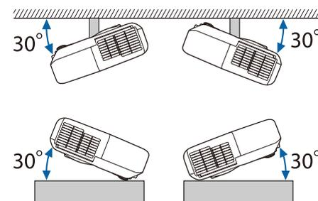
Si vous inclinez le projecteur de plus de 30°, il risque de tomber et d'être endommagé ou de provoquer un accident.
