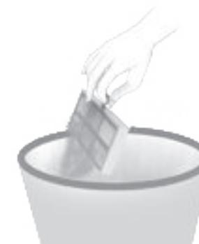
**2** Secouez pour ôter les débris en tapant le filtre contre la poubelle.
