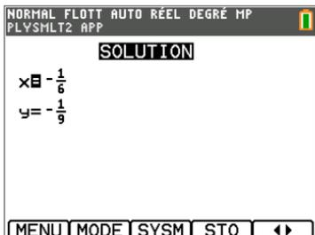
7. Appuyez sur [↔] (graphe) pour passer au format de nombre décimal et en revenir. Les résultats contenant des radicaux et  $\pi$  peuvent ne pas être pris en charge dans le solveur de systèmes.
