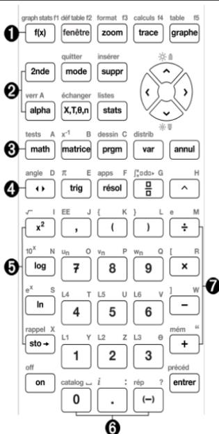
④ Les touches de **permutation, trig, résol et MathPrint™** vous permettent de basculer entre les résultats mathématiques exacts et approchés décimaux, d'accéder aux fonctions trigonométriques, d'accéder au menu de résolution et de travailler avec des fractions et MathPrint™.
