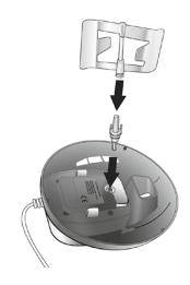
Enclencher le couvercle avec le bloc moteur sur la cuve.
