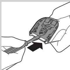
**3** Insérez le tournevis entre le bloc moteur et le panneau arrière de l'appareil. Appuyez le tournevis vers le bas autant que possible
