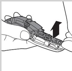
**5** Enlevez les panneaux latéraux. Tirez la partie inférieure du circuit imprimé avec la batterie rechargeable attachée de l'appareil.
