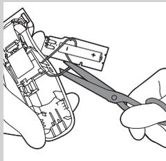
**6** Coupez les fils pour séparer la batterie rechargeable de l'appareil.
