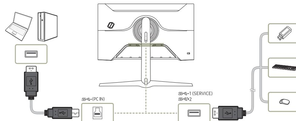
— Pour détecter un dispositif USB et le faire démarrer plus vite, connectez-le au port USB SS-C-1 (SERVICE), SS-C-2 situé sur le produit. Le taux d'écriture / lecture sera affectée par le dispositif USB et votre PC.
