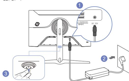
1 Connecter le câble d'alimentation à l'adaptateur CA/CC. Connecter ensuite l'adaptateur CA/CC au port DC 22V à l'arrière du produit.
