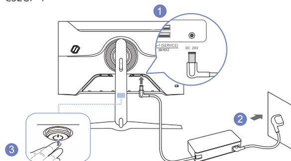
1 Connecter le câble d'alimentation à l'adaptateur CA/CC. Connecter ensuite l'adaptateur CA/CC au port DC 24V à l'arrière du produit.
