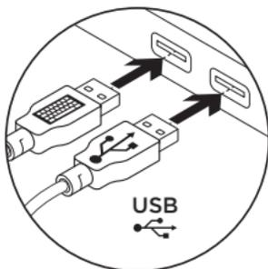
Afin d'utiliser le port de dispositif de relais USB, vous devez connecter les deux câbles USB.
