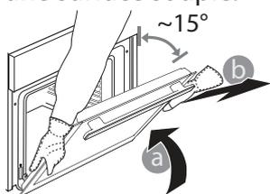
3. Réinstallez la porte en la plaçant devant le four pour aligner les crochets des charnières avec leurs appuis et attacher la partie supérieure sur son appui.
