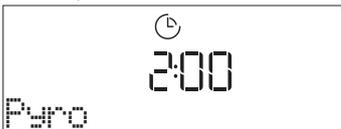
Appuyez sur  $+$  ou  $-$  pour sélectionner le cycle souhaité, puis appuyez sur  $\checkmark$  pour confirmer. Une fois qu'un cycle a été sélectionné, si vous le souhaitez, appuyez sur  $+$  ou  $-$  pour régler l'heure de fin (départ différé), puis appuyez sur  $\checkmark$  pour confirmer.
