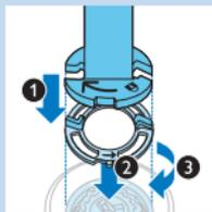
**7** Placez le support de l'anneau de fixation sur l'anneau (1), puis sur la tête de rasage (2). Faites-le ensuite pivoter dans le sens des aiguilles d'une montre (3) pour fixer à nouveau l'anneau de fixation.
