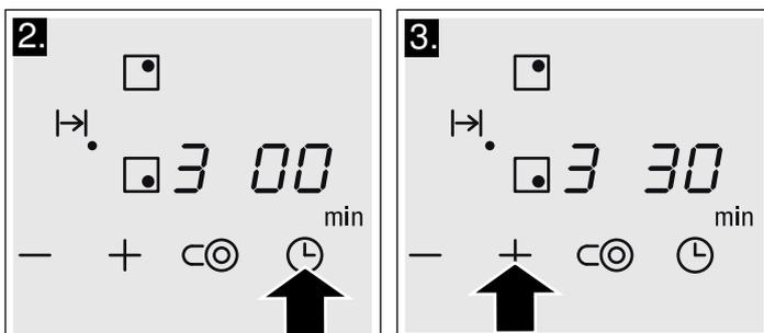
4. Effleurer le symbole + ou -, jusqu'à ce que la durée désirée apparaisse dans l'affichage de minuterie.
