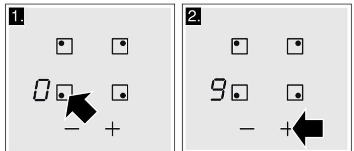
3. Modifier la position de chauffe : Effleurer le symbole + ou -, jusqu'à ce que la position de chauffe désirée apparaisse.
