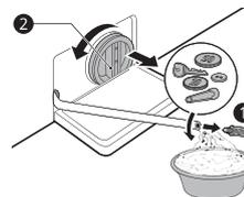
**4** Après avoir nettoyé le filtre de la pompe de vidange, le sortir et insérer le bouchon de vidange.
