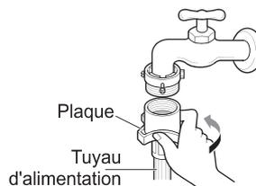
**Raccordement d'un tuyau de type rapide à un robinet sans filetage**
