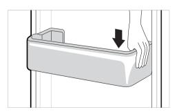
2 Après le montage, appuyer doucement sur le panier de la porte pour le fixer horizontalement.
