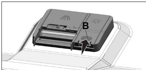
4. S'il y a des taches sur les couverts après le lavage, le niveau doit être augmenté et si vous observez une trace bleue après les avoir essuyé à la main, il doit être diminué. Il est réglé sur le niveau 3 comme réglage d'usine.
