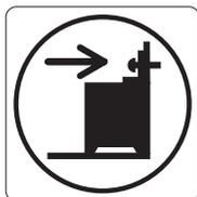
**MISE EN GARDE:** Pour éviter le risque de basculement de l'appareil, le dispositif de stabilisation par les fixations anti-bascullement doit être mis en place.
