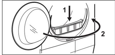
1) Si nécessaire, nettoyez le filtre avec une brosse sous un filet d'eau chaude du robinet et/ou avec un aspirateur.
