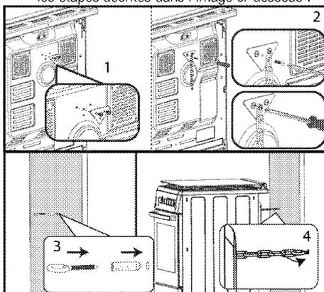
**i** La chaîne de stabilité doit être aussi courte que possible pour éviter que la cuisinière ne bascule vers l'avant et en diagonale. Grâce à cette précaution, la cuisinière ne s'incline pas sur le côté.
