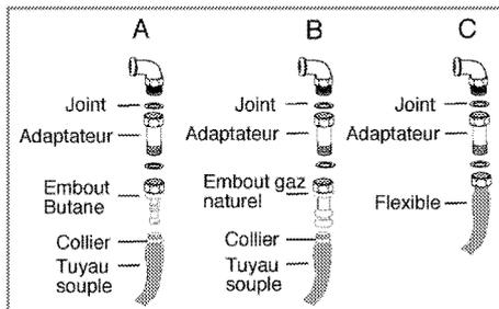
L'embout butane permet le raccordement par tube souple en caoutchouc de diamètre intérieur de 6 mm destiné aux gaz distribués par bouteilles. L'embout pour gaz de conduite permet le raccordement par tube souple de diamètre intérieur de 15 mm, le tube devant être enfoncé suffisamment pour permettre son maintien obligatoire par un collier de serrage. Utiliser un tube portant l'estampille NF-GAZ. Ce tube est à remplacer régulièrement avant la date limite d'utilisation.
