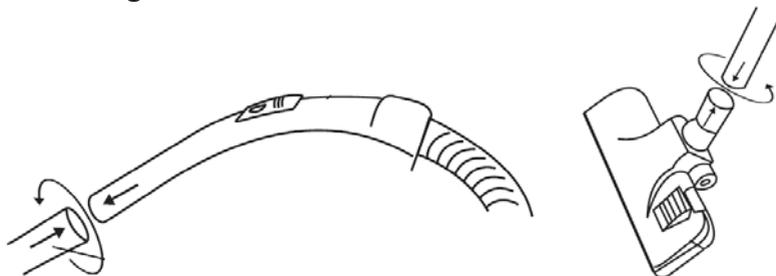
1. Fixez l'extrémité la plus large du tube à la poignée du tuyau.
