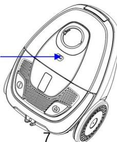
1. Soulevez le loquet de fermeture du capot avant pour ouvrir le bac à poussière.
