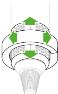
Faites glisser la brosse nettoyante pour filtre sur le cordon d'alimentation et passez-la sur la grille du filtre.
