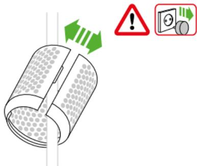
Tenez fermement la poignée de l'appareil et tournez la grille du filtre vers le bas, sur le cordon d'alimentation.
