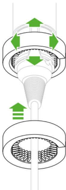
À l'aide d'un mouvement rotatif vertical, nettoyez le filtre avec la brosse nettoyante prévue à cet effet jusqu'à ce que tous les débris aient été éliminés.
