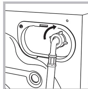
2. Raccorder le tuyau d'arrivée de l'eau au lavante-séchante en le vissant à la prise d'eau prévue, dans la partie arrière en haut à droite (voir figure).
