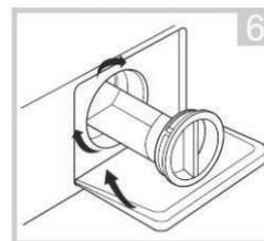
Réinstallez le filtre et fermez le couvercle du filtre.
