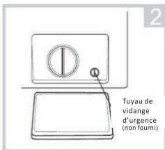
Faites-le pivoter sur 90°, sortez le tuyau de vidange d'urgence et retirez le capuchon du tuyau.
