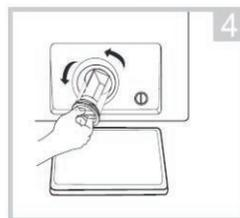
Retirez le filtre en le tournant dans le sens contraire des aiguilles d'une montre.
