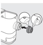
Pressez le disque de forme par l'ouverture du support du disque de forme, 6 puis montez le support sur la sortie du compartiment de mélange. Faites tourner le support dans le sens des aiguilles d'une montre pour le fixer fermement
