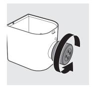
4 Mettez votre doigt dans le compartiment de mélange et poussez le tube de pressage vers l'extérieur pour le faire glisser hors de la sortie du compartiment de mélange. Détachez le disque de forme, puis tirez la barre de pressage hors du tube de pressage.
