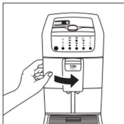
3. Retirez le tuyau à lait du mousseur à lait.
