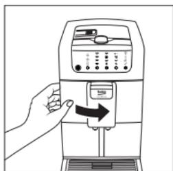
3. Détachez le tuyau de de distribution sur la porte en le tirant légèrement vers l'avant de la partie intérieure de la porte 2 et en poussant à gauche 3, so dass er aus der Klemmung ausrastet. de sorte qu'il se dégage du serrage.
