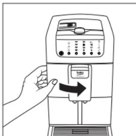
3. Retirez le réservoir à marc de café en le sortant de l'appareil.
